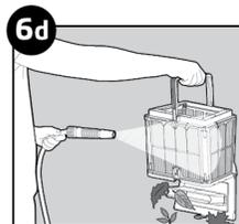
Nettoyez le panier de filtrage au moyen d'un jet d'eau.
